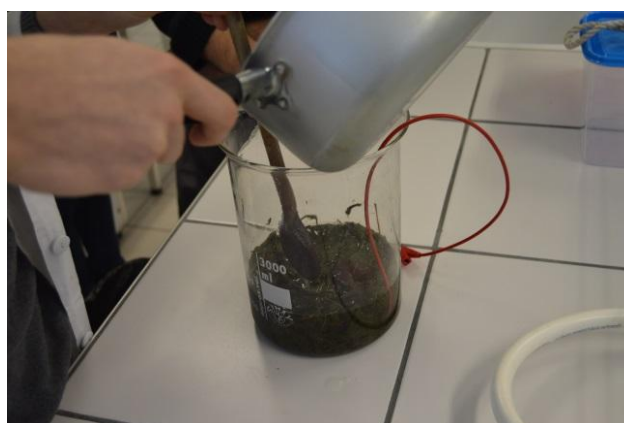
Fig 8 : coulage du pont salin
