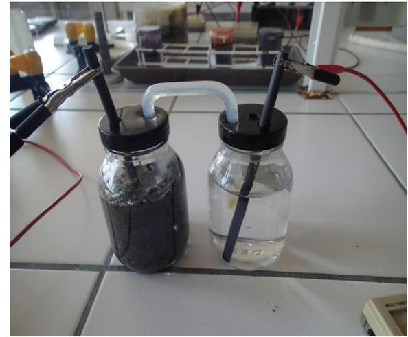
④ anode : cylindre de carbone
