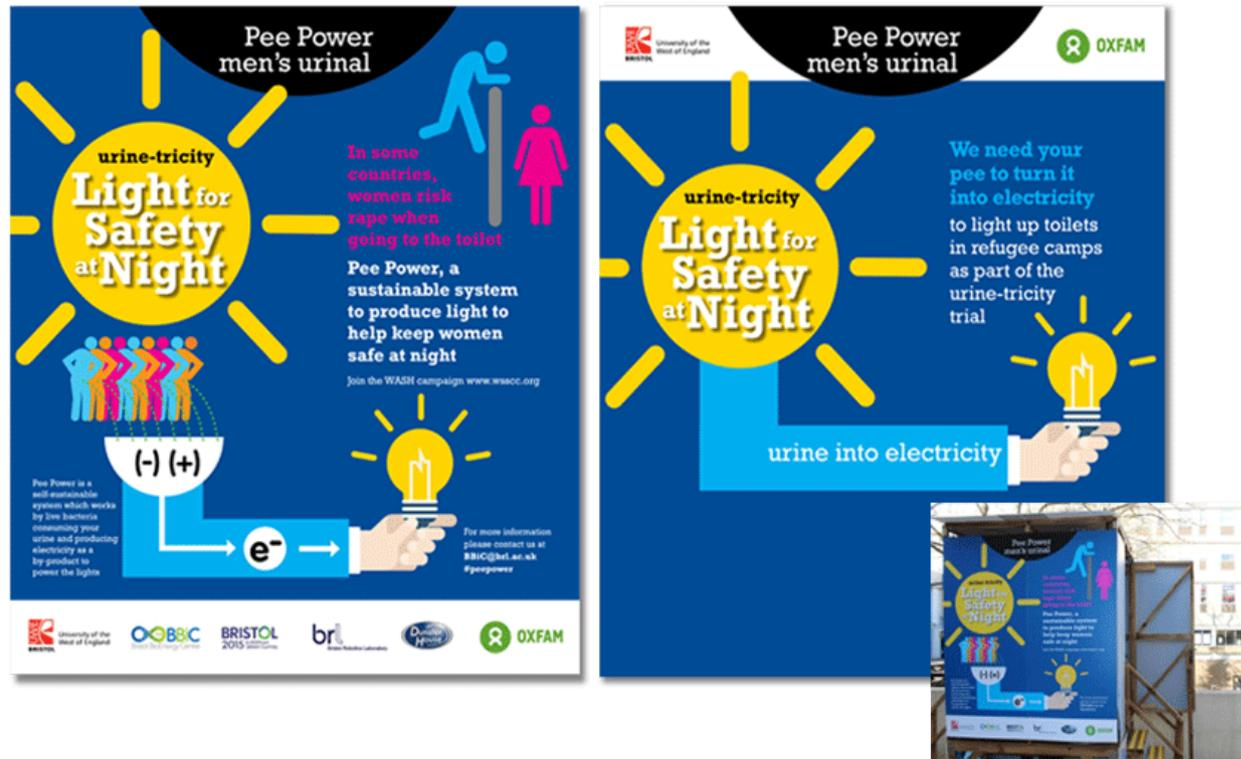
A l'université de Bristol, des chercheurs ont mis au point un WC dont l'électricité est générée par une pile microbienne alimentée par l'urine des personnes l'utilisant ! Quelques prototypes ont été installés dans des camps de réfugiés en Afrique.
