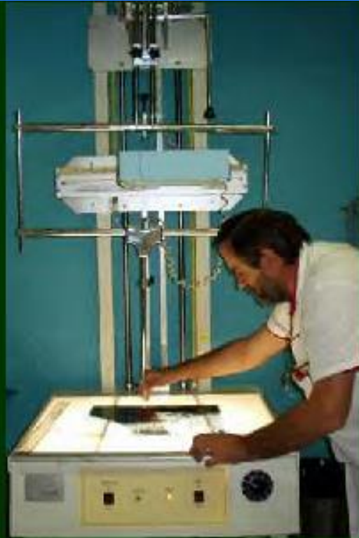
Fabrication et moulage des protections (des tissus sains) pour chaque patient.
